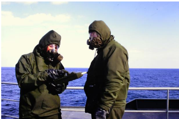
Figure 12 Testing av deteksjonsutstyr CAM (Chemical Agent Monitor). Foto: Bjørn Peter Berdal.
